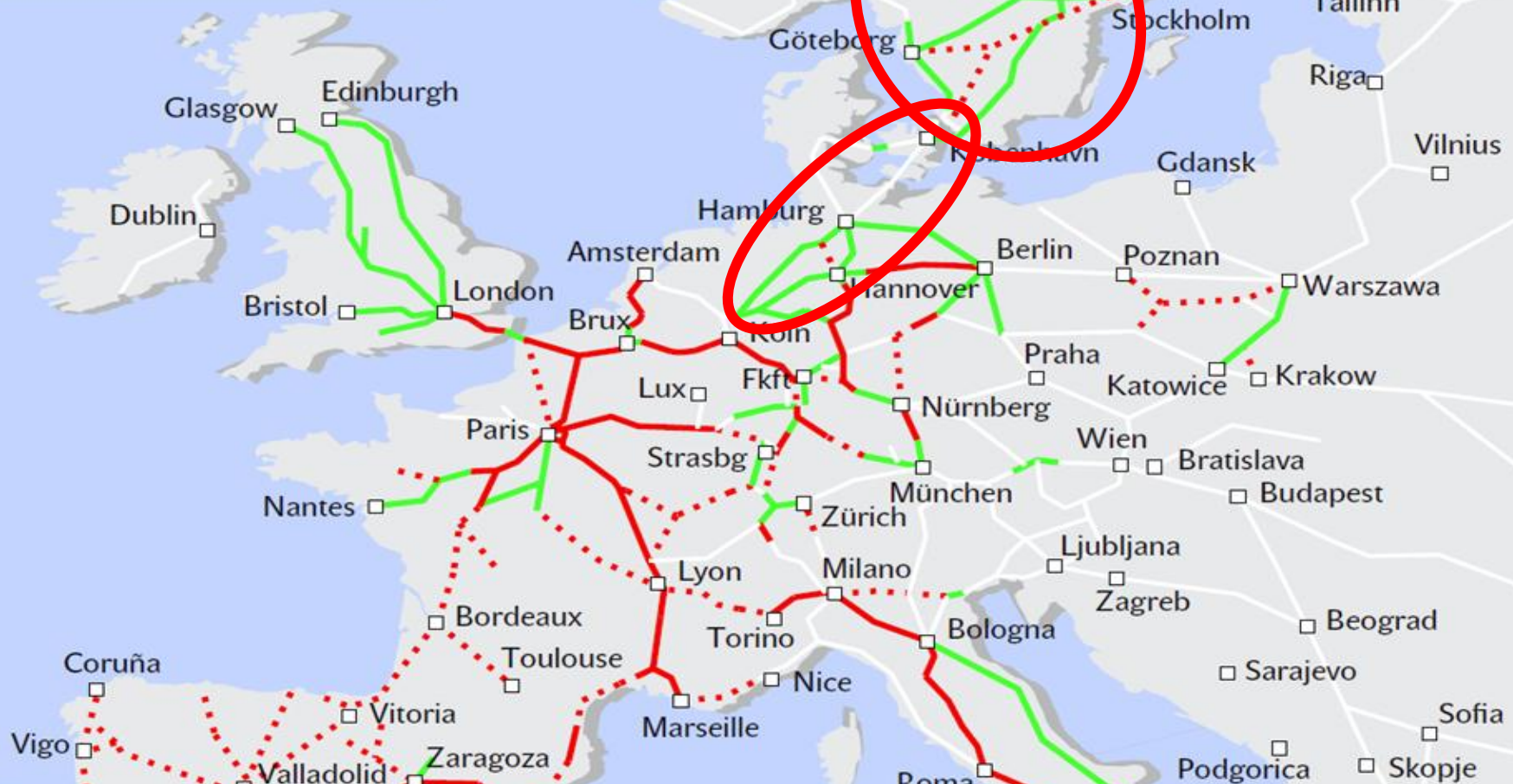
Figur 57. EU's Trans-Europæiske Net med de 6 prioritetskorridorer (i rød) hvor navnlig anlæg af højhastighedsbaner dominerer. På kortet er indtegnet en mulig nordeuropæisk korridor (i blå). Grundkort: UIC 2010.
